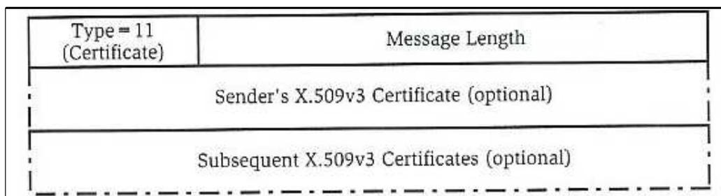
FIGURE 4.19 – Structure d'un message de négociation Certificate
