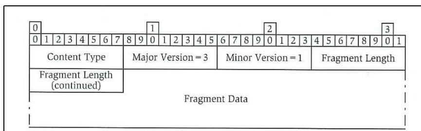
FIGURE 4.9 – En-tête d'un enregistrement SSL
