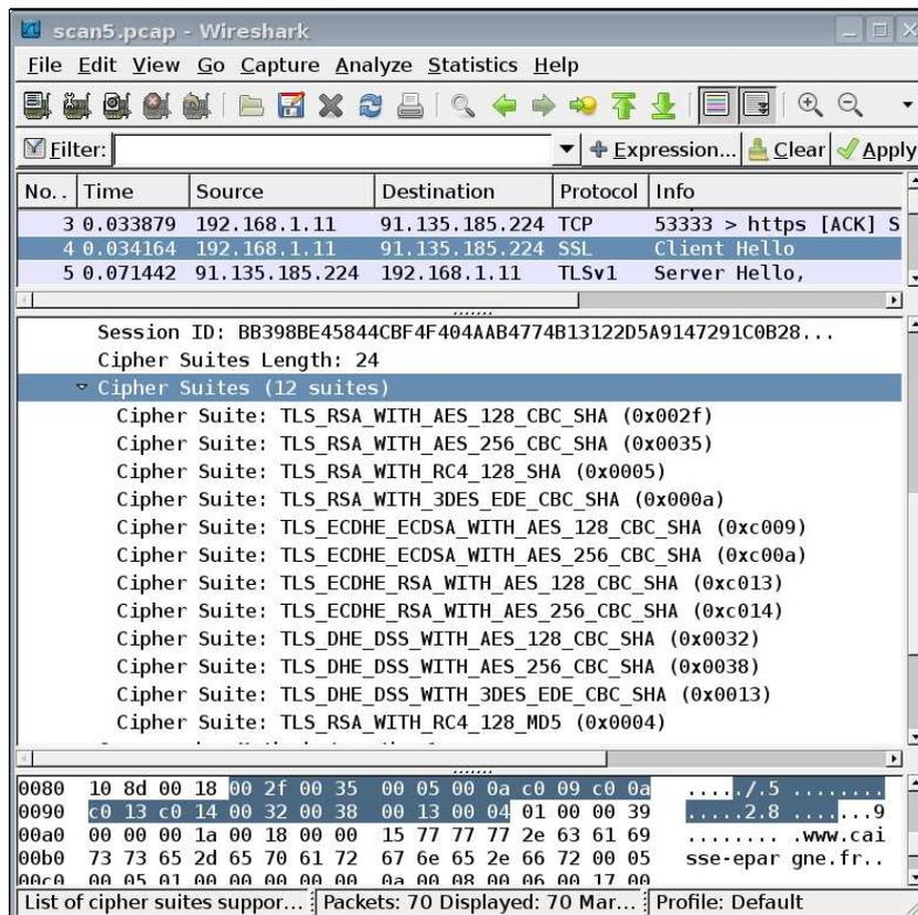
FIGURE 4.16 – Liste des algorithmes de sécurité d'un Client Hello
