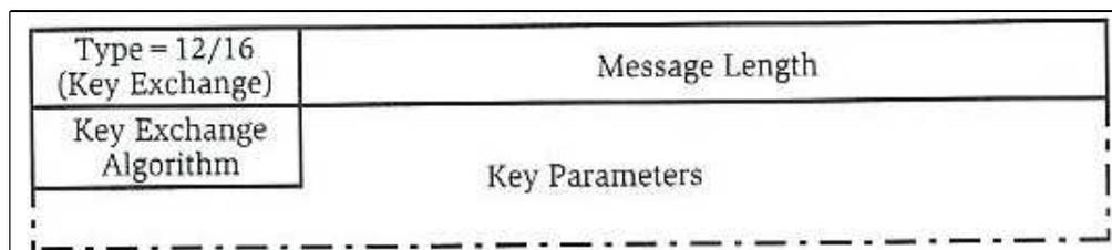
FIGURE 4.24 – Structure d'un message de négociation Key Exchange
