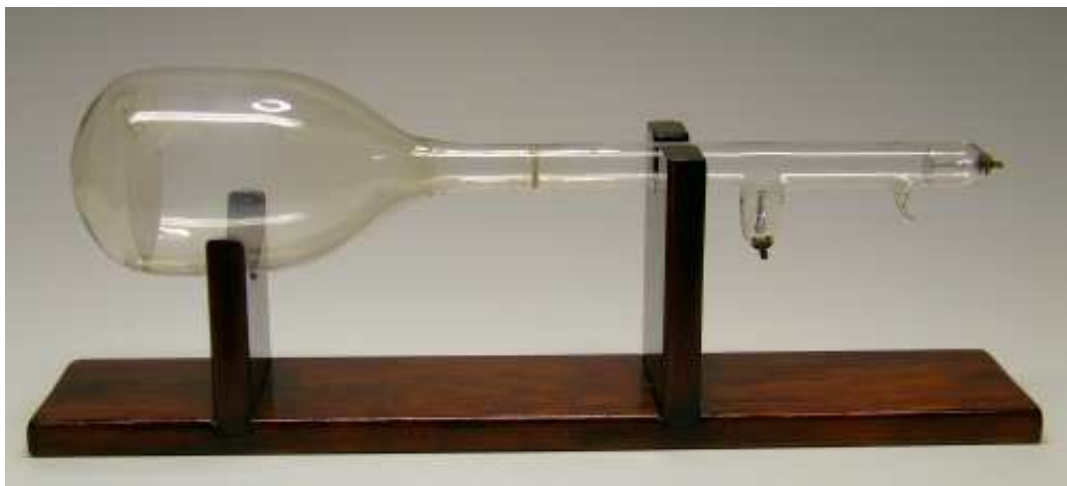
FIGURE 7.13 – Le tube de Braun est un tube de Crookes ayant un écran de mica interne recouvert d’une peinture phosphorescente
