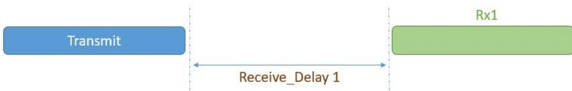
Figure 18. Réception d'un paquet sur la fenêtre RX1.
