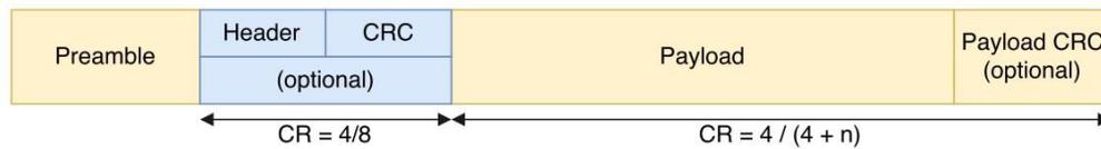
Figure 11. Format d'une trame LoRa.
