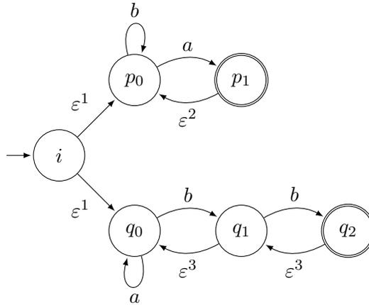
FIGURE 1 – L'automate  $\mathcal{A}_{\text{ex}}$ , défini avec epsilon-transitions sur l'alphabet  $\Sigma := \{a, b\}$ . Les exposants sur les  $\varepsilon$  sont à ignorer pour l'instant.
