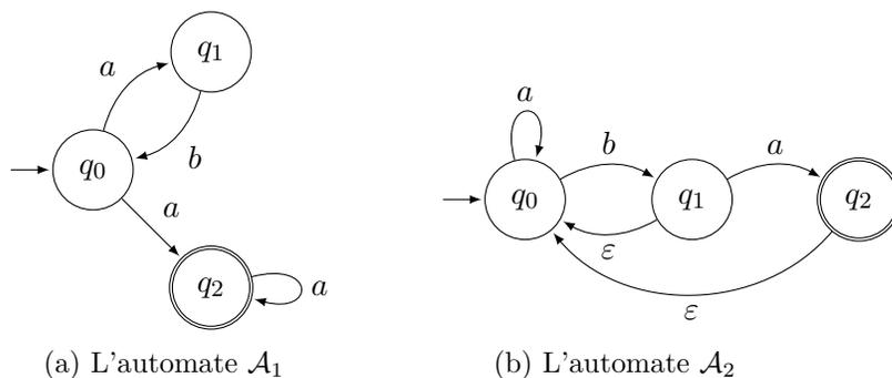
FIGURE 1 – Deux automates sur l'alphabet  $\Sigma := \{a, b\}$ .
