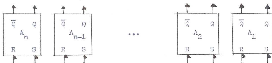
FIGURE 5.3 – Principe d'un registre à bistables
