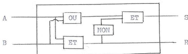
FIGURE 3.8 – Réalisation d'un demi-additionneur
