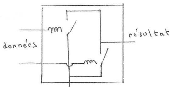
FIGURE 3.5 – Principe de réalisation d'une porte OU
