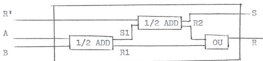
FIGURE 3.10 – Réalisation d'un étage d'additionneur
