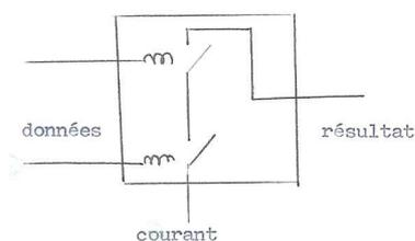
FIGURE 3.6 – Principe de réalisation d'une porte ET
