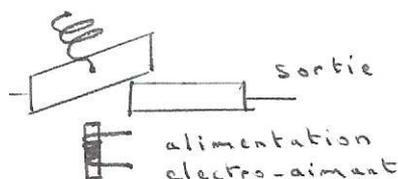
FIGURE 3.2 – Principe d'un relais
