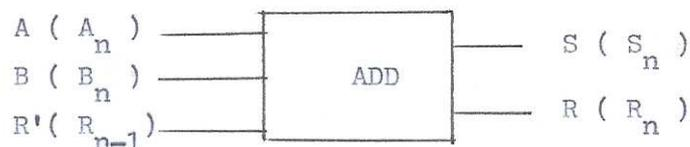
FIGURE 3.11 – Notation d'un étage d'additionneur
