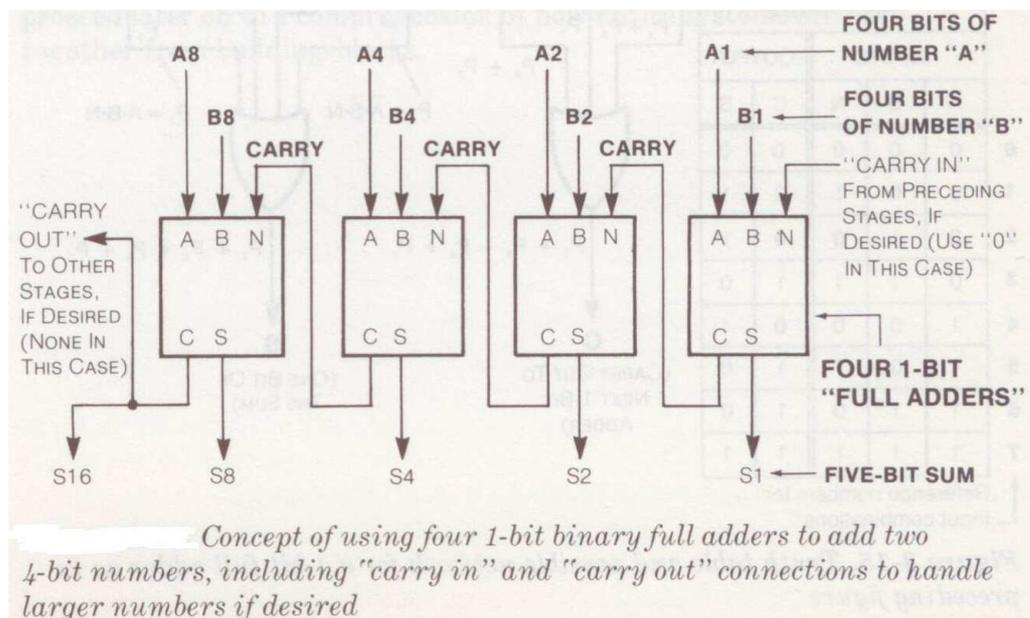
FIGURE 3.13 – Additionneur binaire parallèle
