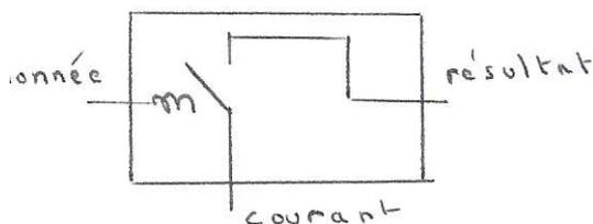
FIGURE 3.4 – Principe de réalisation d'un inverseur
