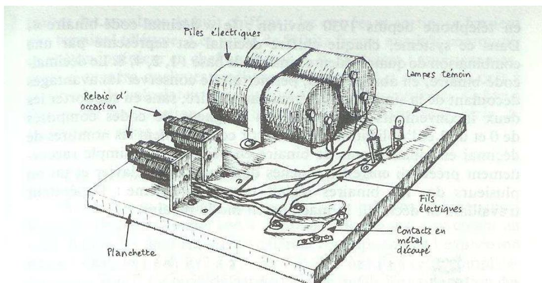
➤ **Le premier circuit binaire expérimental de Stibitz.** Ce que pouvait être le « modèle K », l'additionneur expérimental de G. Stibitz. L'exemplaire original a été perdu et les photos généralement publiées sont celles d'une réplique construite postérieurement.
